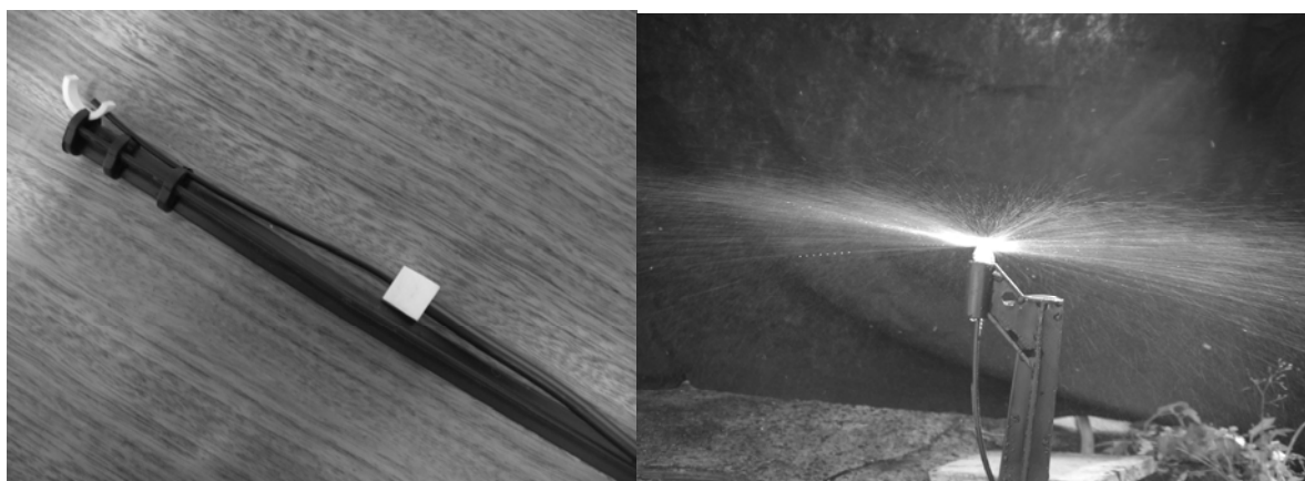
Figura 01 - Microaspersor com microtubo como emissor, utilizado neste estudo.
